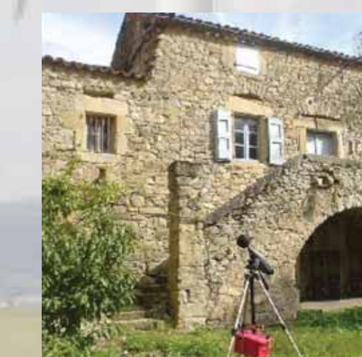
Exemple de sonomètre installé chez un riverain afin de mesurer les niveaux sonores ambiants
