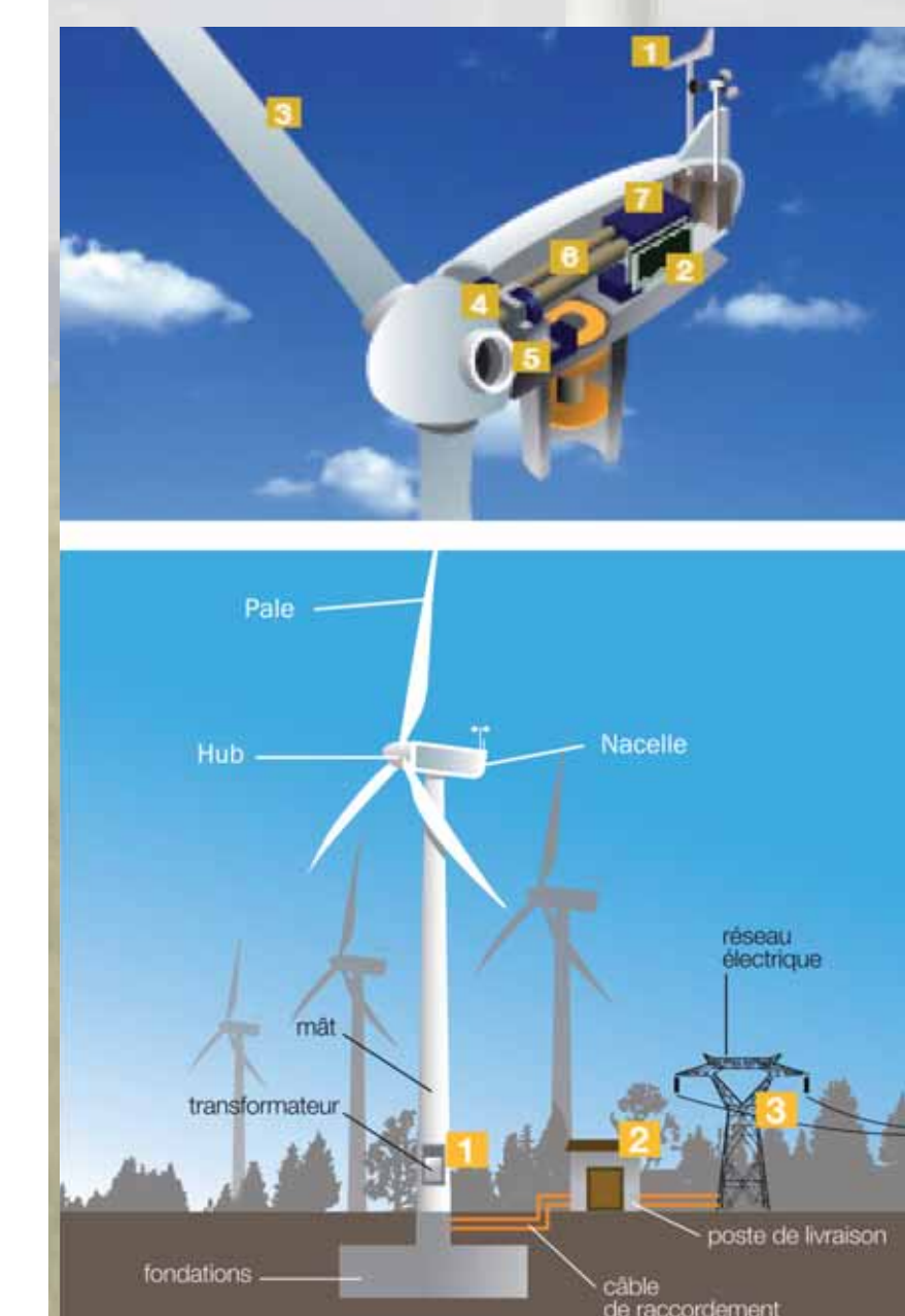
Schéma de fonctionnement d'une éolienne
